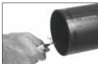
Odstranění otřepů a nerovností řezu
